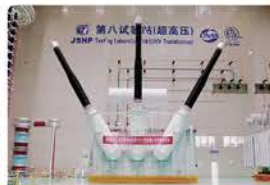
美国765kV超高压变压器
